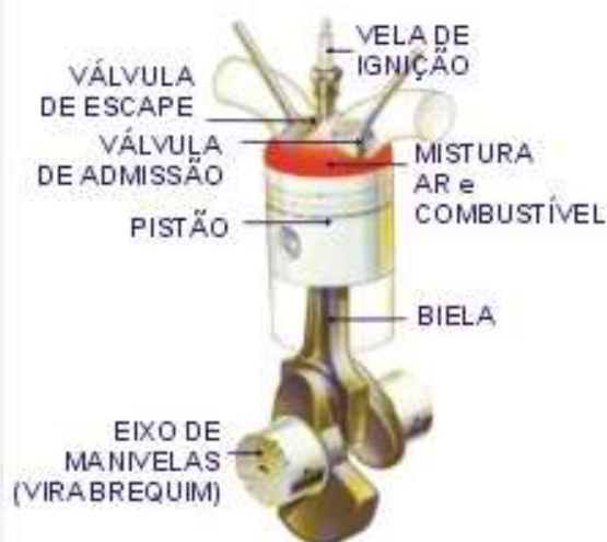
Figura 2.7 - Pistão de MCI de Ignição por Compressão (PABLO HENRIQUE CARVALHO LEMES – PUC Paraná – 2010 - Acessado em http://www.ebah.com.br – Abril
